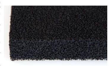
Die Funktionsweise von Aktivkohle geht zum einen auf die Adsorption von Partikeln und Gasen, und zum anderen auf die katalytische Fähigkeit beim Abbau bestimmter Stoffe zurück. Bei der Adsorption kleben Kohlenstoff- und Schadstoff-Moleküle aufgrund von Bindungskräften zusammen. Die grosse Oberfläche ist hier von Vorteil, um möglichst viele Schadstoffe zu binden. Gleichzeitig tritt Aktivkohle als Katalysator auf und kann z.B. beim Abbau von Ozon helfen.
